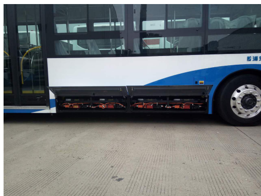
图 3.4.2 车右侧高压电池舱
